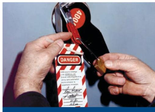
6. Libérer toute énergie emmagasinée dans le système. Selon le genre de machine, **plusieurs types d'énergie peuvent demeurer** après que le courant est coupé. La procédure écrite sur le verrouillage doit donner une liste complète de toutes ces sources d'énergie secondaire et les étapes à suivre pour les libérer.
